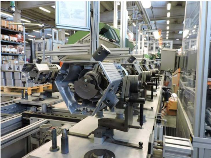
**Testate compressori in montaggio in linea.**
